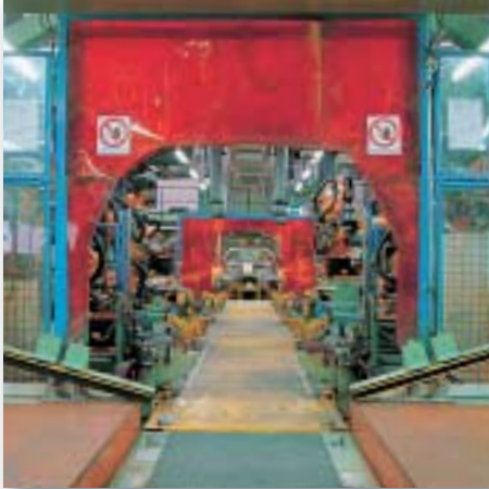
Surveillance d'une ligne de montage avec le PSENopt pour la protection de l'accès.
