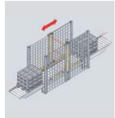
Muting dans un ou deux sens (version en L et version en T).
