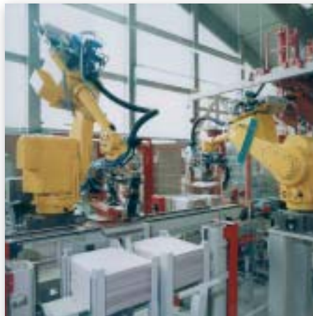
Surveillance de robots avec le PSENOpt pour la protection des mains.
