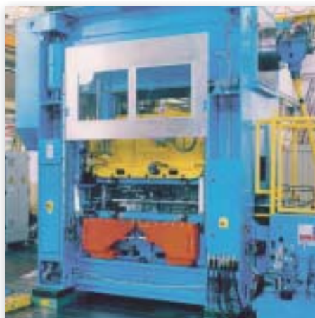
Surveillance d'une presse avec le PSENOpt pour la protection des doigts.
