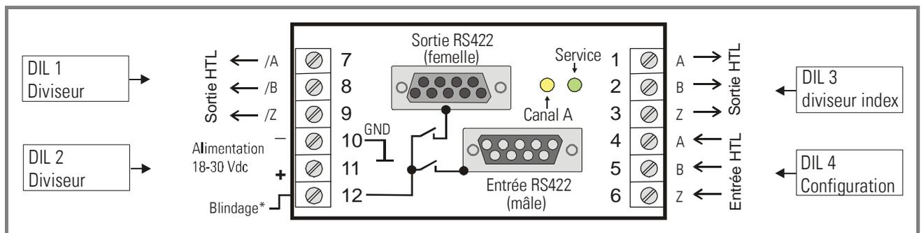
\*) La borne « Blindage » permet le raccordement des boîtiers métalliques des 2 prises SUB-D à un potentiel externe en 12, quand les commutateurs DIL correspondantes sont fermés (voir DIL 4).
