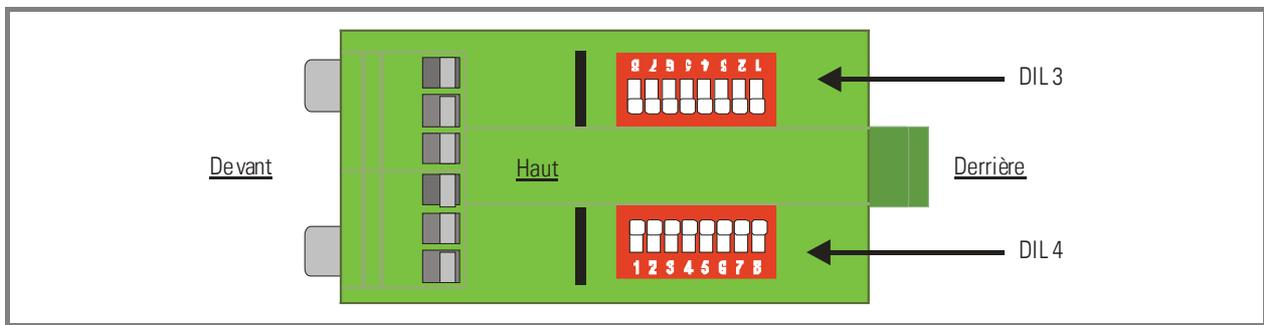
Les commutateurs DIL3 et DIL4 se situent sur la partie supérieure de l'appareil, les commutateurs DIL1 et DIL2 sur la partie inférieure.
