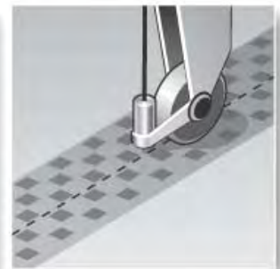
Guidage de lame par un fil métallique, par ex. pour la découpe de textiles.
