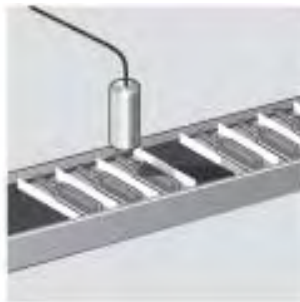
Installations de conditionnement. Ampoules au complet?*
